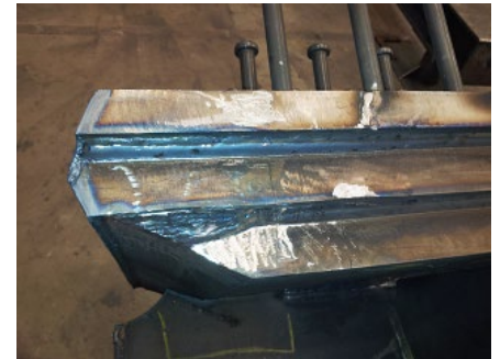
Bild 7. Lamellenpaket Werkstatt Stahlberggurt (Foto: 2013 Donges Steeltec GmbH) Fig. 7. Manufacturing multi-disks upper belt
